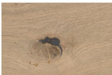
ペースト状の充填剤で生節の割れや死節の穴を埋めることを指します。また、くぼんだ部分を埋めて滑らかにします。
