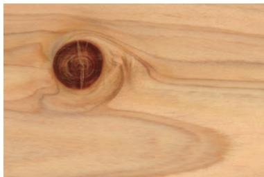
成長によって枝が幹に包まれた部分で製材すると枝の形成などの形になって出てきます。木の自然な風合いを感じさせます。
