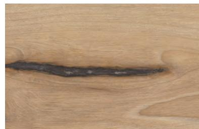
樹皮が傷つき始めた部分が、成長過程で木の内部に残り、筋状に変色している部分を指します。節ありグレードに入ることがあります。
