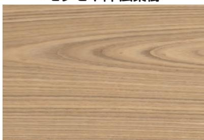
はっきりした木目が特徴で、硬く粘りがあり、加工しやすい材質です。フローリングのほか家具や野球のバットなどにも使用されています。
